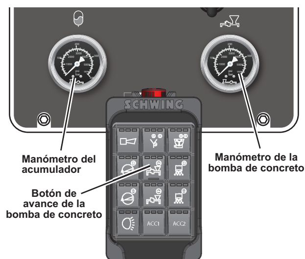
Figura 7 Manómetros y control remoto colgante
